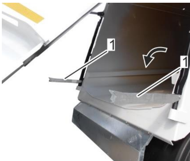
Рисунок 2 Откидывание защитных опор
